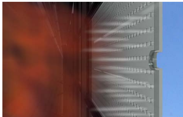
Wentylatory zasysają świeże powietrze do systemu, które miesza się z gorącym powietrzem. Powierzchnia jest chłodzona, a straty ciepła są zminimalizowane.
